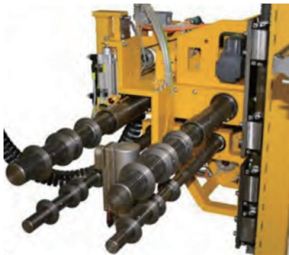
操纵机构 - 13 英寸胎圈直径位置的 4 杆扩胎器（最小值）
