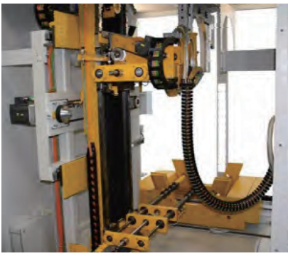
操纵机构 - 30 英寸胎圈直径位置的 4 杆扩胎器（最大值）
